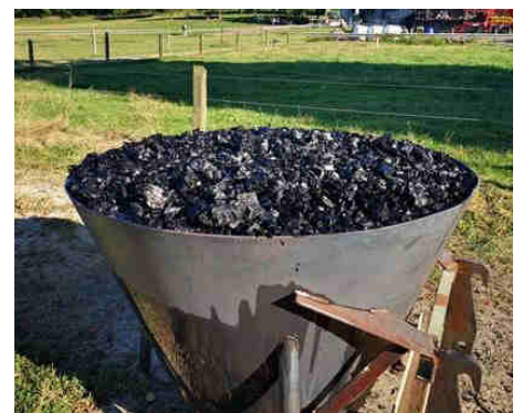
Das Holz wird Stück für Stück aufgeschichtet, damit sich das Feuer von unten nach oben entwickelt und so die Kohle übrig bleibt.
