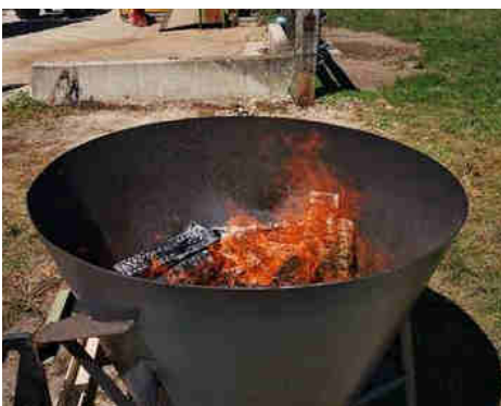
Der Prototyp einer zur Holzkohle Herstellung geeigneten Feuerschale wurde in Zusammenarbeit mit einem Landwirt und nach Plänen vom ithaka Institut erstellt.
