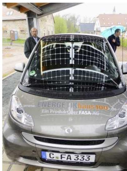
**Elektro-Fahrzeug in Carport mit halbtransparentem Photovoltaik-Dach.**
