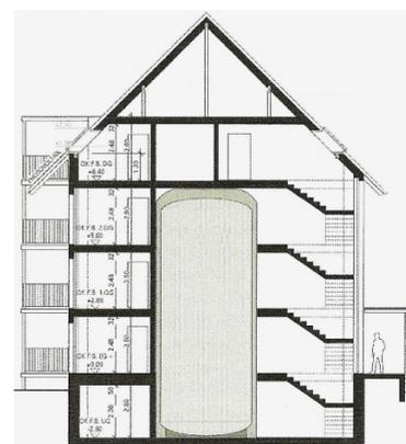
Querschnitt der Mehrfamilienhäuser mit eingebautem Solarspeicher. Bild: zvg
