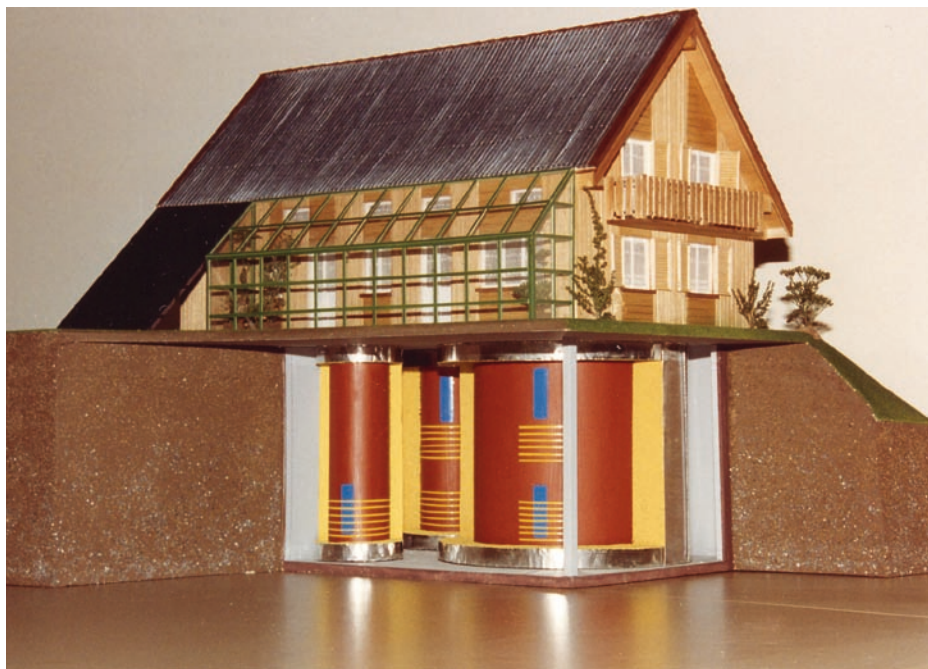
Die Pufferspeicher des im Jahr 1989 erbauten Sonnenhauses befinden sich unterhalb der Erde.
