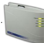
Datenlogging (Aufzeichnen der Messwerte), PC- und Web-Interface (Fernüberwachung und Fernwartung via Internet)
