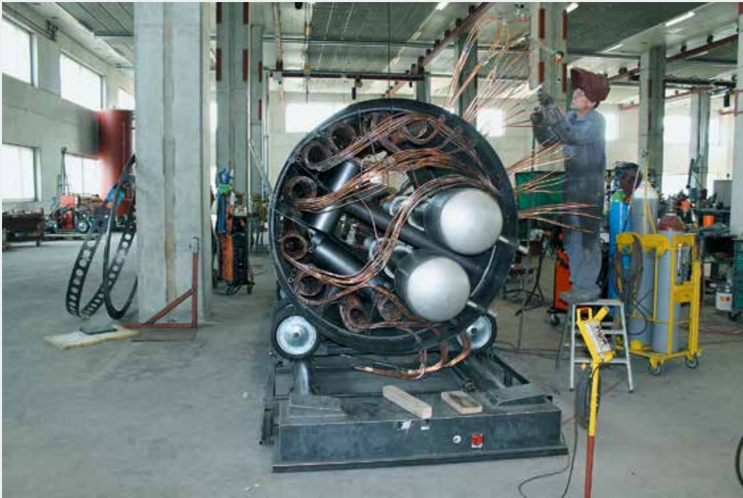
Produktion des Wärmespeichers mit integrierten Boilern und Wärmetauschern. Fabrication de l'accumulateur combiné avec boilers intégrés et échangeurs de chaleur.
