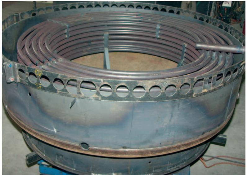
*Unterer Teil eines Wärmetauschers für einen Warmwasserspeicher mit einem Inhalt von rund 12 000 Liter. Dazugehörige Solarkollektorfläche: 150 m<sup>2</sup>.*
