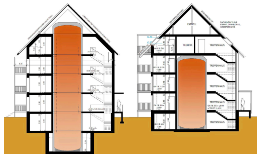
Die neuen Solarhäuser (rechts) weisen einen deutlich kleineren Solarspeicher und weniger Kollektorfläche auf. Damit steht mehr Wohnraum zur Verfügung – die Wirtschaftlichkeit kann optimiert werden. (Bilder: Jenni AG)
