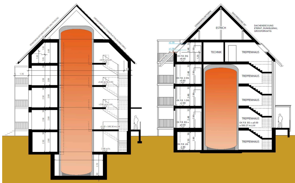
Die neuen Solarhäuser (rechts) weisen einen deutlich kleineren Solarspeicher und weniger Kollektorfläche auf. Damit steht mehr Wohnraum zur Verfügung – die Wirtschaftlichkeit kann optimiert werden. (Bild: Jenni AG)
