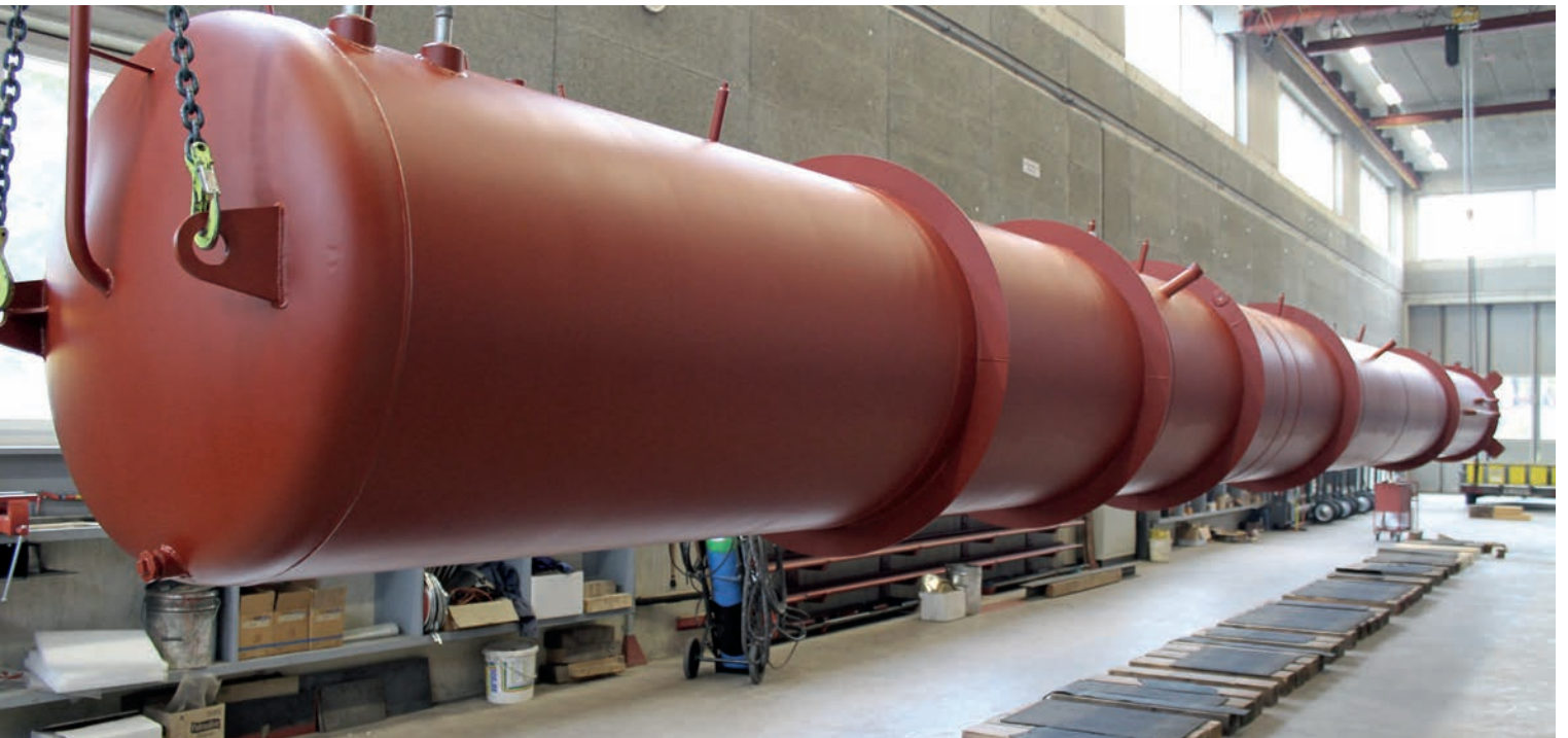
Wasser-Wärmespeicher: 19 m lang, Durchmesser 110 cm, Inhalt 17 600 Liter. (Foto: Jenni Energietechnik)
