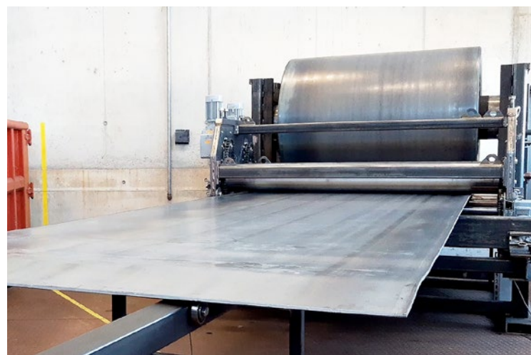
Die neue Abcoilanlage für Blechdicken von 10 bis 15 mm bewährt sich.
