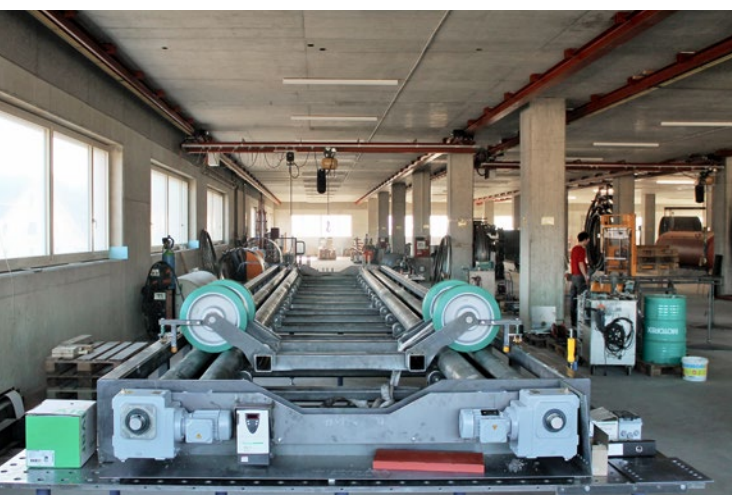
Vorrichtung zum Schweißen von schwergewichtigen Energiespeichern
