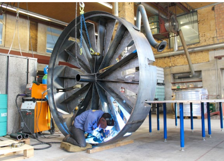
Fertigung einer variablen Speicherboden- Pressvorrichtung
