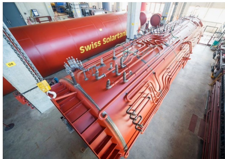
Energiespeicher für eine Überbauung mit 54 Wohnungen in Mettmenstetten
