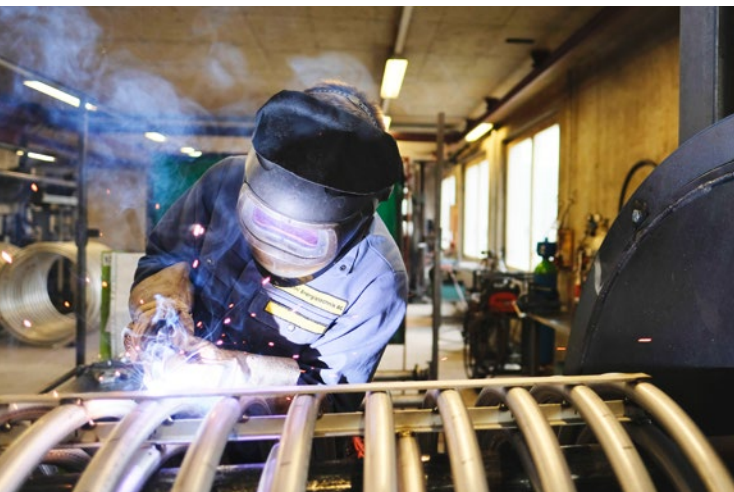
Produktion eines Mehrfach-Wärmetauschers
